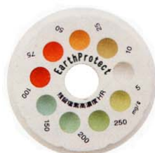
● 残留塩素高濃度測定 H R 5~250mg/l
