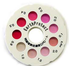
● 残留塩素低濃度測定 DPD-A 0.1~2.0mg/l
