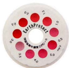
● 残留塩素中濃度測定 DPD-C 0.5~5.0mg/l
