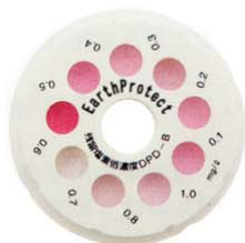
● 残留塩素低濃度測定 DPD-B 0.1~1.0mg/l
